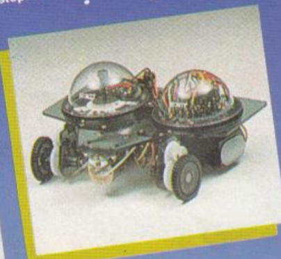
NAVIUS MV-938 È un robot controllato mediante dischetti programmabili. È in grado di riconoscere il bianco e il nero del dischetto programmato e quindi muoversi in avanti, a destra, a sinistra o fermarsi.
